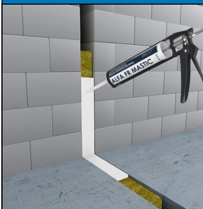
Rys. 5 Szczelina w ścianie s \geq 100 mm
